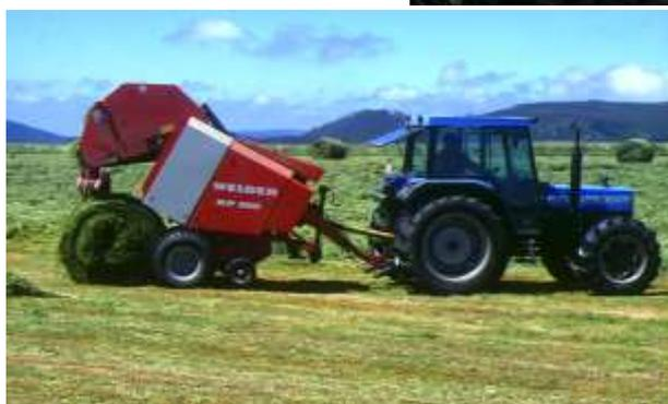
Figura 8.27.- Rotoempacadora trabajando sobre hierba ligeramente prehenificada para ensilar. Illano (Asturias).
