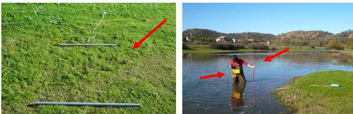
**Figura 2:** a) Electrogrid que fue utilizado durante los muestreos de pesca. b) Medida de las variables (profundidad, velocidad y sustrato) en grids y puntos de transectos.
