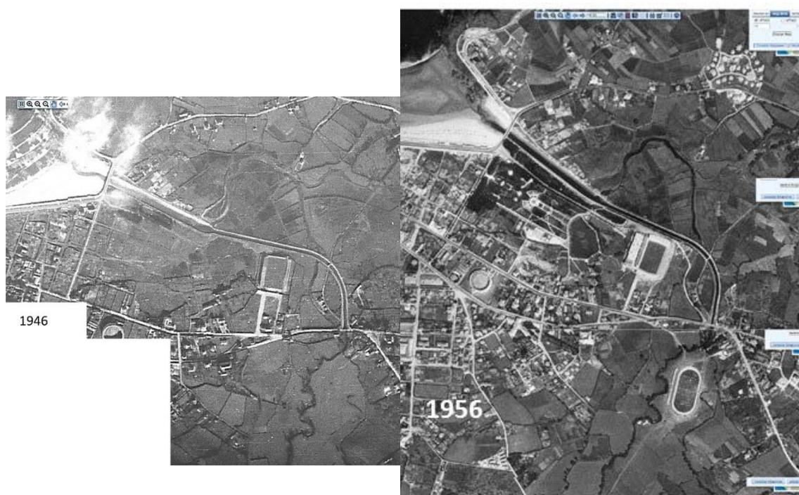
**Figura 2.6.-** Fotos aéreas de los vuelos americanos de 1946 (izquierda) y 1956 (derecha) mostrando la parte final del río Piles rectificadas y canalizadas.
