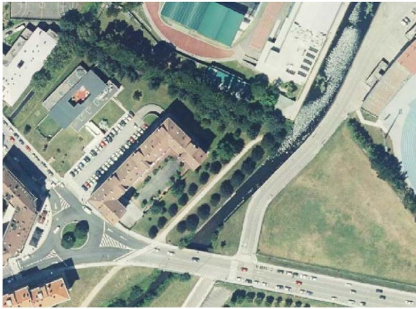
**Figura 3.3.-** Estrechamiento del cauce del río Piles aguas abajo del cruce con c/Albert Einstein, forzado por la presencia de la vía de acceso a Las Mestas.
