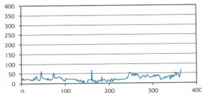
Figura 1. Variación del hidrograma diario del río Tajo, en un año antes de la regulación y en un año con el régimen regulado
