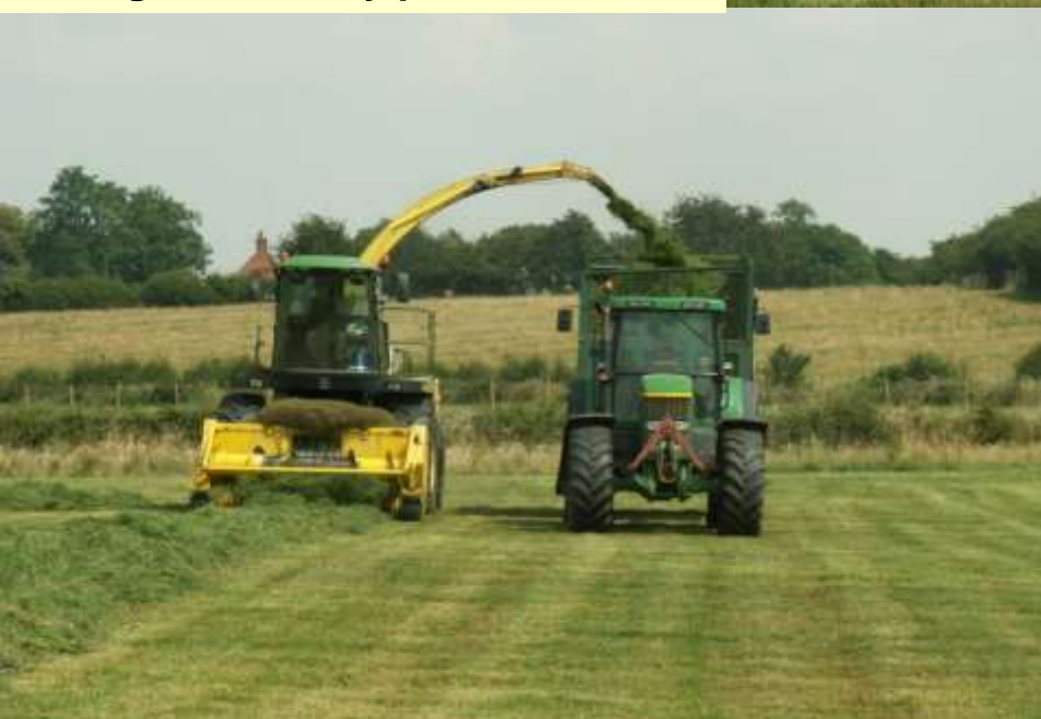
3: picado y paso a contenedor
